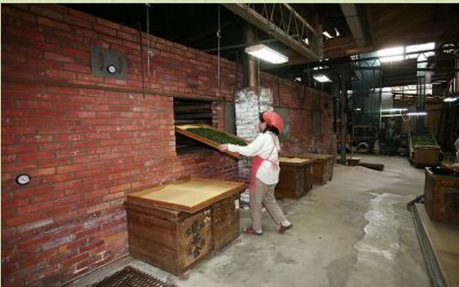
↑碾茶を乾燥させるための碾茶用レンガ製乾燥炉
