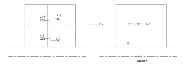
マンション戸数 6 戸、流末各戸給水管口径 20mm、共用栓 1 栓の場合。 既設加入金の合計額と新設加入金の差額を徴収する。
