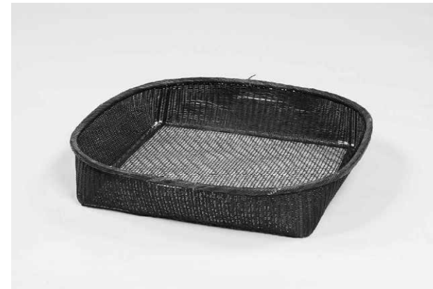
1-0125 K120-4 トオシ 茶葉のふるい分けや仕立て上がった茶の大きさを揃えるために使用。かつては藤で作られていたが、近年は竹で編んだものが多い。
