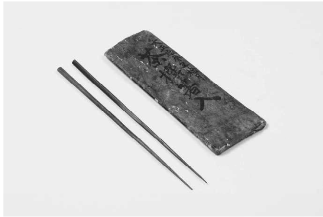
1-1215-1 茶撰箸 撰別の最終段階で細かい作業をするために使われる。
