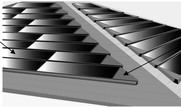
屋根面と太陽光パネルの段差を目立たせないような措置を施します。
