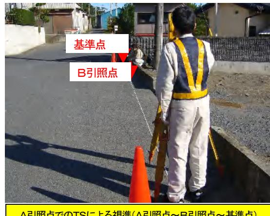
A引照点でのTSによる視準(A引照点～B引照点～基準点)
