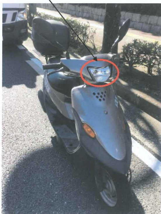
ヘッドライト破損
