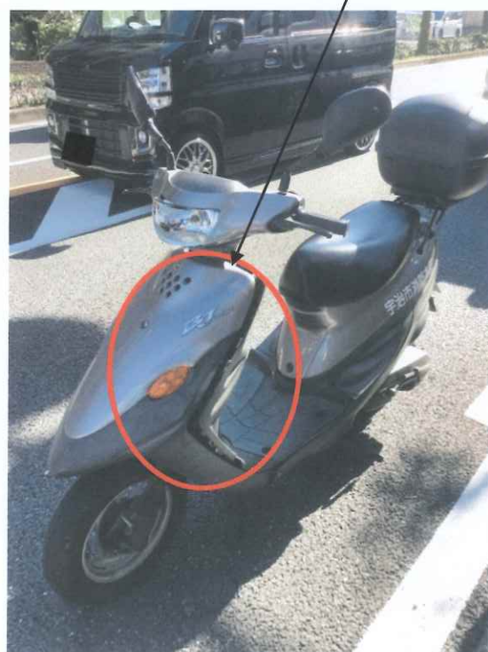
フロントカウル破損
