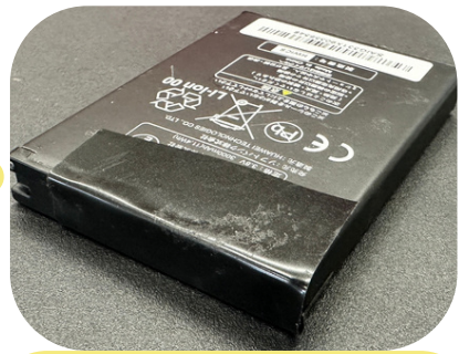
電極が見えないように絶縁する
