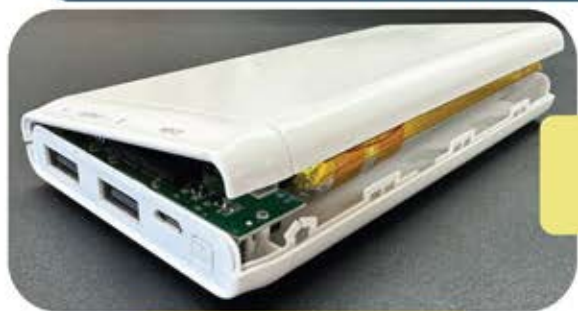
膨らんだ充電電池
