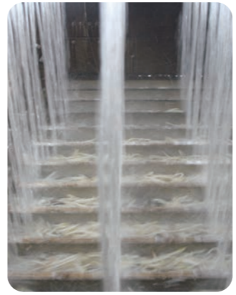
上からのシャワー水で下のスリット部に根を押し込み、横スライドのカッターで根っこをカット
