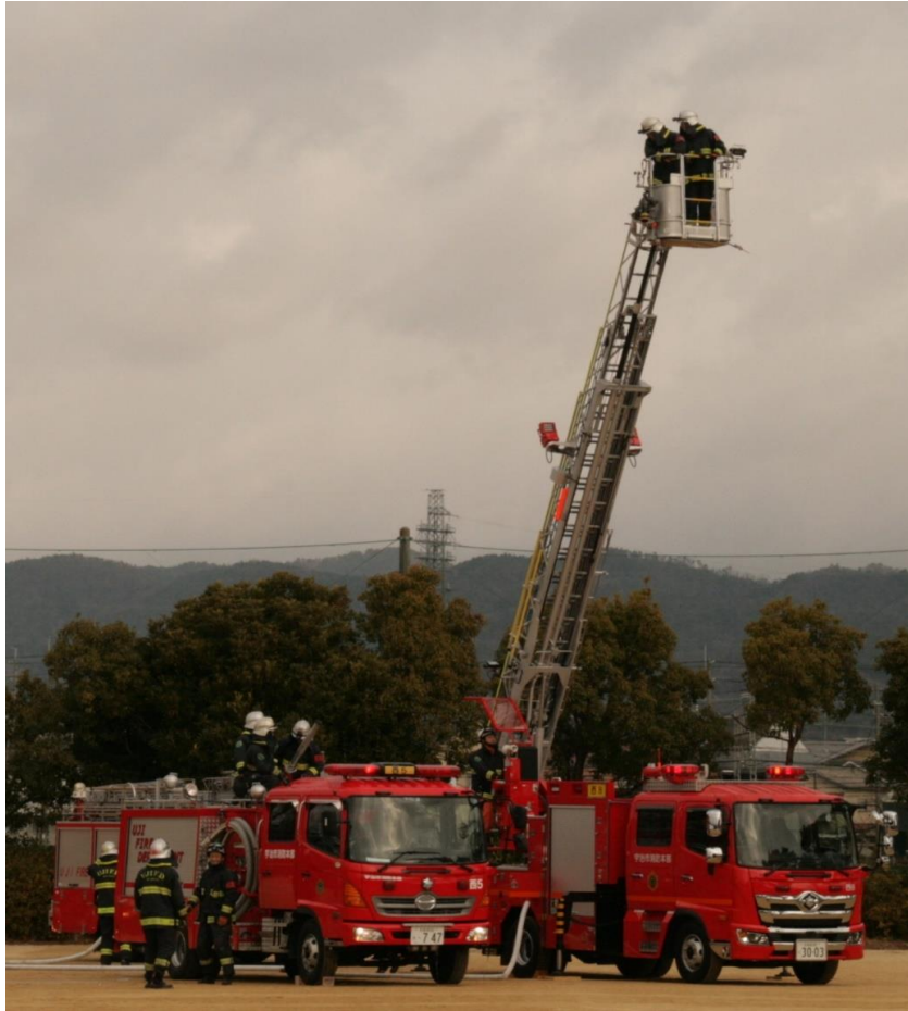
化学消防ポンプ自動車（左） 15M級はしご付消防自動車（右）
