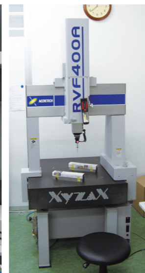
3次元測定機で寸法管理
