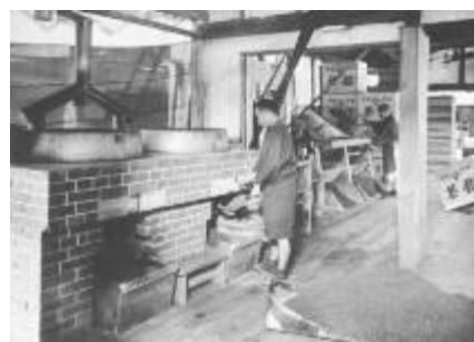
近代化された製茶乾燥機と冷釜 (大正4年刊『京都府久世郡写真帖』より)
