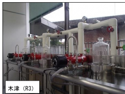
連続臭気監視装置（連続的に水を温め蒸気化させる装置）
