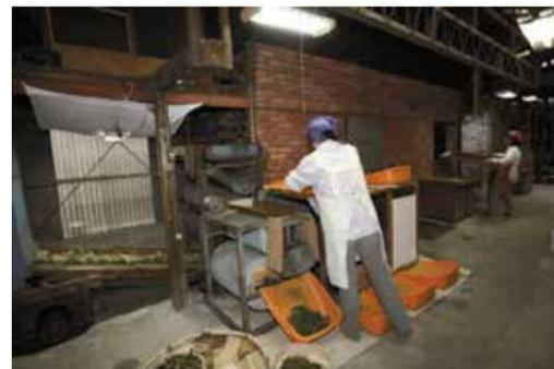
図 60 煉瓦造碾茶乾燥炉での乾燥と荒茶選別作業
