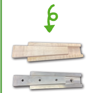
木材の部品（上）から金属部品（下）を製作
