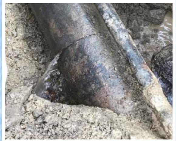
破損した水道管の漏水
