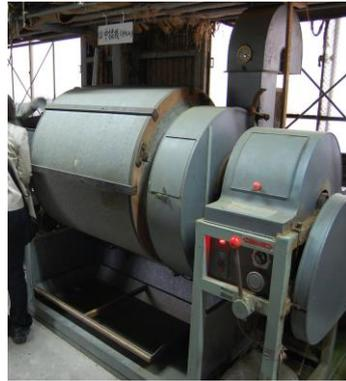
④精揉機（熱と力を加えて、揉みながら乾かす） ⑤乾燥機（乾かす）
