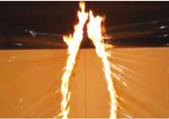
シートに火が燃え広がる様子 (写真提供 枚方寝屋川消防組合消防本部)
