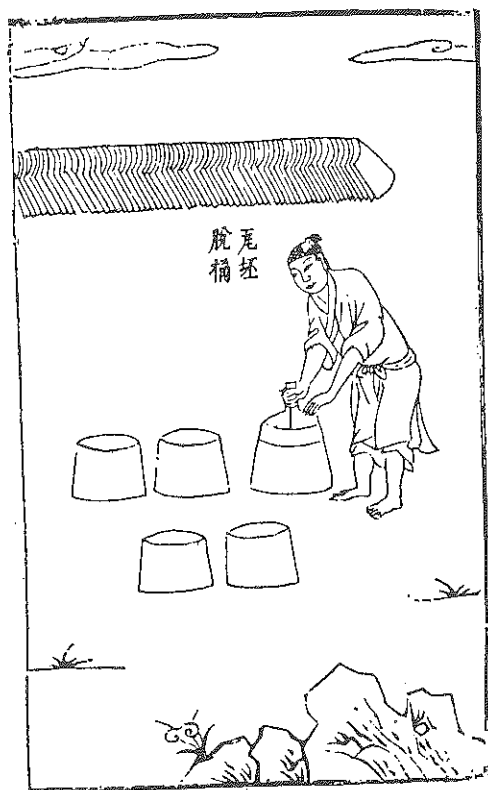
Fig. 22 中国明代瓦作りの様子(『天工開物』より)
